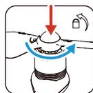
Drücken Sie den Propeller auf die Befestigungsplatte, und drehen Sie ihn in die Verriegelungsrichtung, bis er fest sitzt.
